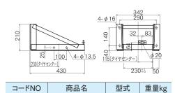
2930140 取付ブラケット L-230 7.10 ※大型トラック「PLシリーズ」(U溝型)の機種に対応
