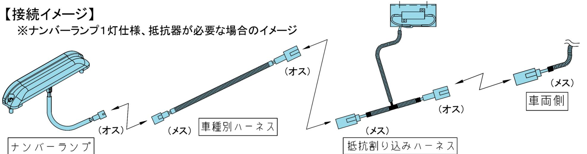
※抵抗器自体は発熱します。抵抗器の熱が周囲に影響を及ぼさない様、周辺部品とは十分に距離を確保してください。
