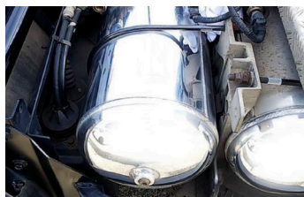
▲エアータンク
