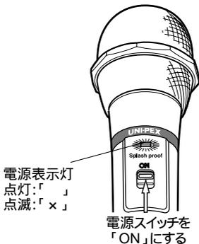
電源スイッチを入れ、電源表示灯が点灯すれば設定したグループ/チャンネルは正常です。
