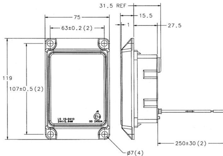
推奨ランプ取付け穴（寸法単位：mm）
