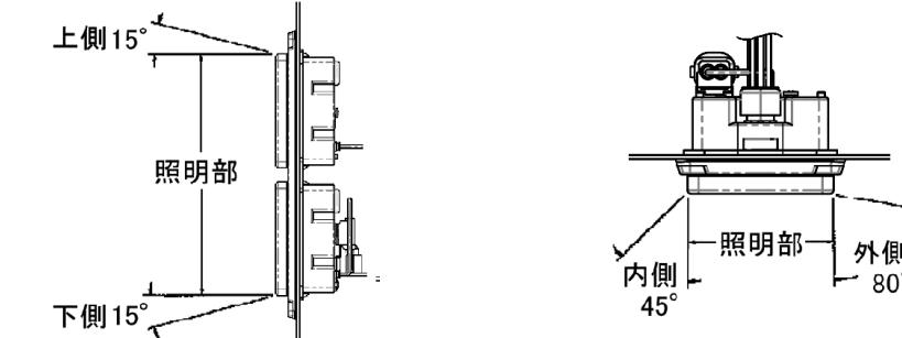
※上図の角度範囲でランプ照明部が見通せるように取付ける事。
