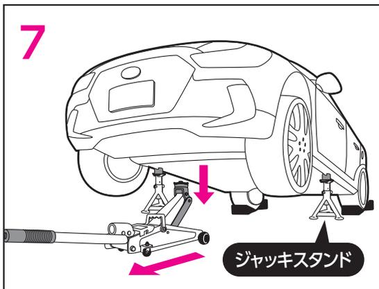
7 ジャッキスタンドを、車両のジャッキポイントの真下になるように合わせて置き、ジャッキスタンドが車両を維持するまでリリースバルブを反時計回りにゆっくり回し、ジャッキダウンします。
