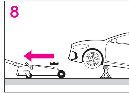
8 ジャッキスタンドが、車両を完全に支えていることを確認し、ジャッキのサドルを下げ、安全なところまで、車両から離してください。
