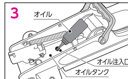
3 オイル量を確認します。オイル注入口から油面まで約3mm以上の空間がある場合は適正量までジャッキ専用作動油【別売】“P14 関連商品 参照”を注油してください。
