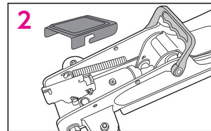
2 カバーを固定しているボルトを取りはずし、カバーを取りはずしてください。オイルプラグをプライヤーなどの工具ではずしてください。
