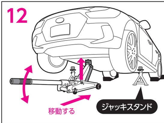
12 作業後、再びジャッキをジャッキポイントまで移動させ、リリースバルブを時計回りに回してリリースバルブを確実に締め付け、ジャッキスタンドが取りはずせる高さまでジャッキアップします。
