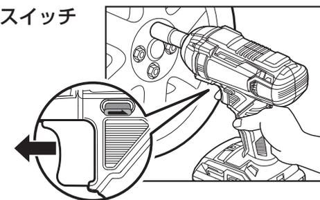
5. 仮締め後、必ずトルクレンチ (別売) を使用して、規定のトルク値で本締めします。
